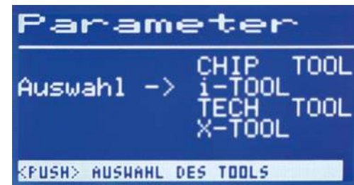
I saldatori sono riconosciuti automaticamente dalla stazione che li imposta sulle temperature reimpostate.
